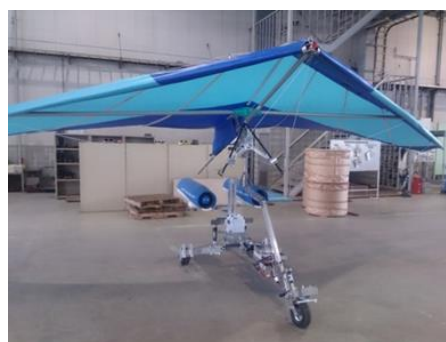
図表 2-14 無人飛行機システム(UAS)用小型ジェットエンジンと滑空試験用機体(宮崎氏提供)
